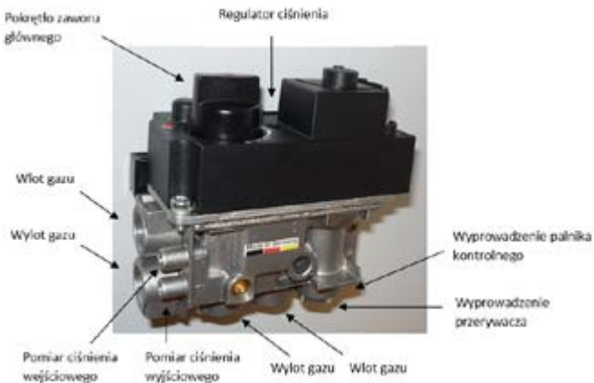
Rys. 13. Sterownik GV60 w pozycji podstawowej
