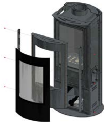
Rys. 16. Sposób demontażu szyby
