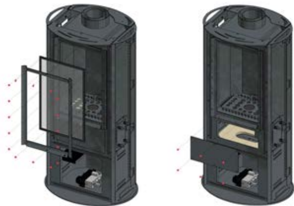
Rys. 11. Demontaż szyby wewnętrznej i rewizji w ogrzewaczu Koza AB GAZ
