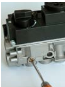
Rys. 15. Sposób regulacji minimalnej wysokości płomienia palnika głównego
