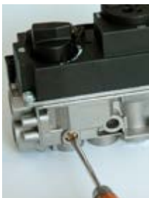
Fig. 15 Réglage de la hauteur minimale de la flamme du brûleur principal
