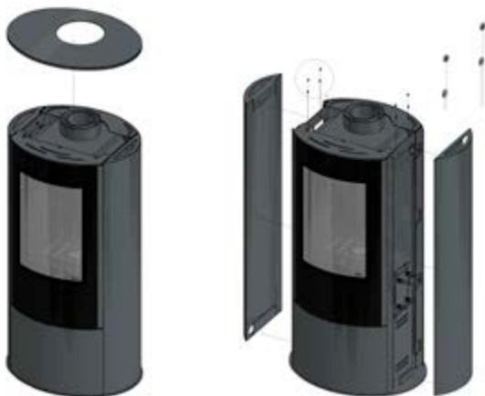
Fig. 8 Méthode de retirer le panneau supérieur et les parois latérales du chauffage Koza AB GAZ
