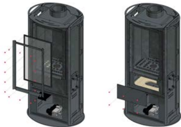
Fig. 11 Méthode de retirer la vitre intérieure et la révision du chauffage Koza AB GAZ
