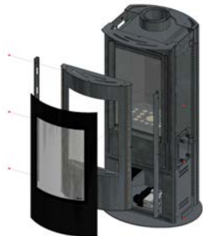
Fig. 16 Méthode de démontage de la vitre
